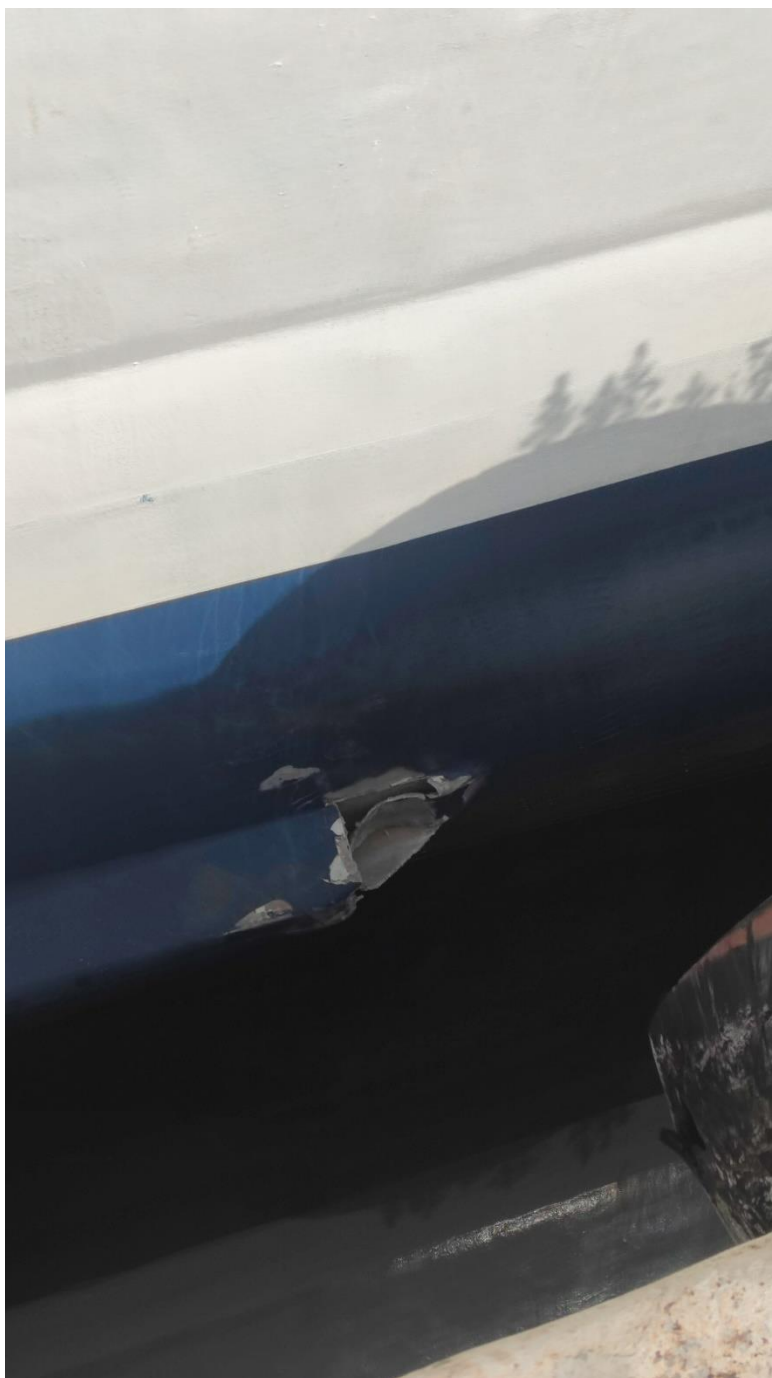
Slika 3. Vidljiva oštećenja na desnoj donjoj bokoštitnici
