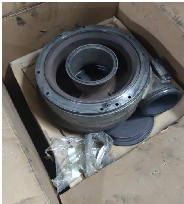
Slika 9. Rabljena reparirana turbina katamarana „Bišovo“
