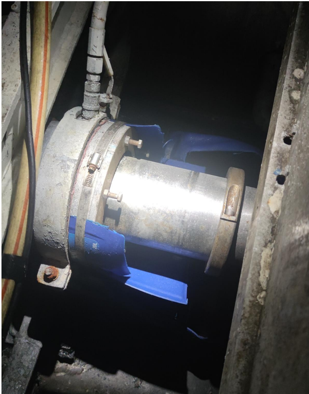
Slika 8. Problematična osovinu desnog pogonskog stroja
