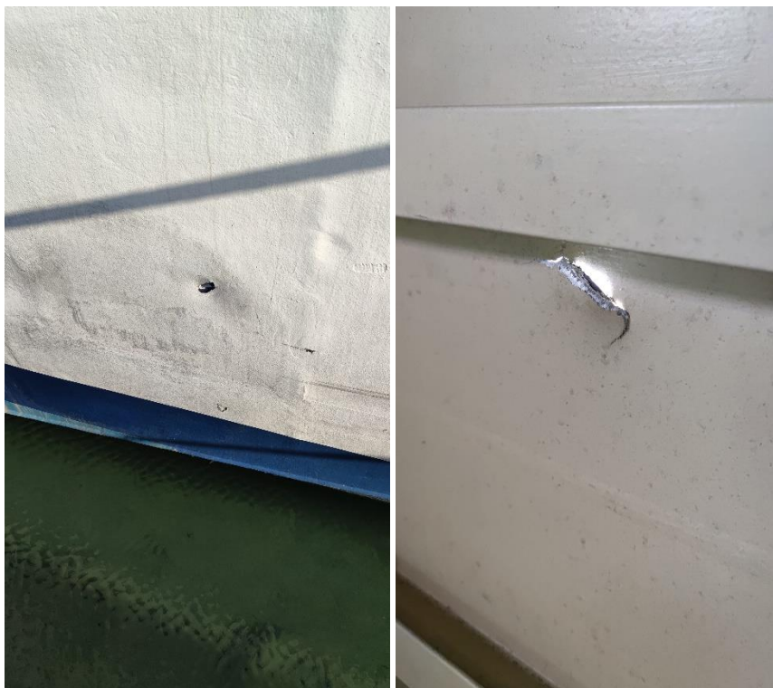
Slika 2. Manja oštećenja na desnoj oplati broda sa vanjske i unutrašnje strane
